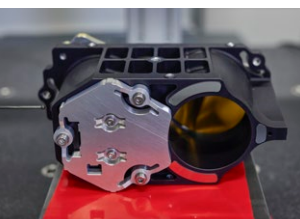
LisR detektiert aus dem Orbit heraus Wärmestrahlung und misst somit physikalisch die Landtemperatur.
